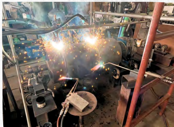
粉碎ロール硬化肉盛り 硬度Hv≒600
